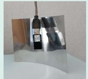
金属反射板を試す。電波強度が2~14dBm改善するも固定に難あり不採用。
