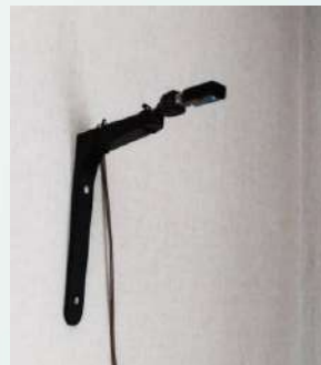
親機の位置などを調整後再度子機位置を調整。壁面に棚受け金具で固定。 電波強度: -47~-55dBm
