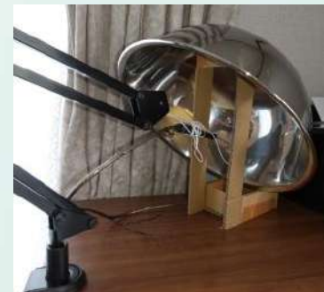
金属ボウルを試す。直径(波長の10倍程度欲しい)不足か効果不明。固定に難あり。
