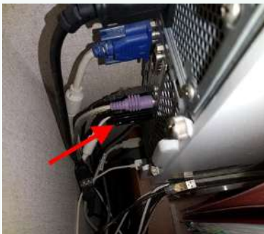
デスクトップ裏面取付子機(部屋の隅) 電波強度: -75~-65dBm
