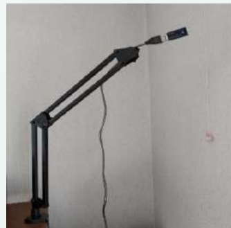
電波強度の強い所を探索中。子機を手で持つと電波が弱くなりかつ安定しない。
